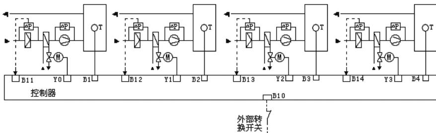
使用说明: 选择分离功能, 组态设置: Y0和B1, Y1和B2, Y2和B3, Y3和B4组合, 设置各个独立控制回路的P,I,D参数和温度设定值。组态可以选择正作用(表冷)或者外部控制方式。
