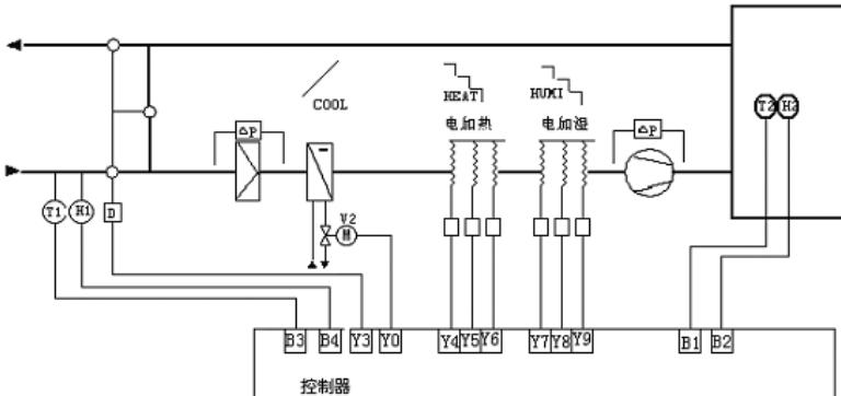
**使用说明** 按默认接线端子定义来接线, 选择焓值控制功能, 在热湿设备选择时选择三档电加热和三档电加湿器。系统自动计算焓值, 当室外焓值低于室内, 全开新风。
