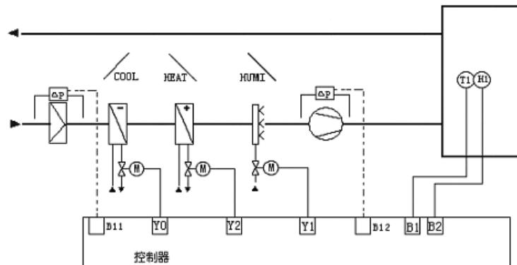
**使用说明** 按默认接线端子定义来接线, 系统自动转换工况, 注意取消分离控制功能, 分别设置好冷却, 加热, 加湿, 除湿的PID参数, 设置好温湿度设定值。在热湿设备选择时选择蒸汽或热水加热器, 干蒸汽加湿器。在湿负荷偏大情况下, 为了达到湿度控制, 可能导致温度偏低, 系统自动启动再热来控制温度, 所以存在冷热抵消; 相反, 在热负荷相对偏大的情况下, 为了降低温度, 可能导致除湿过量, 所以系统自动启动加湿来控制湿度, 所以存在加湿去湿抵消。控制器能最大限度的减少这种能量浪费的情况。
