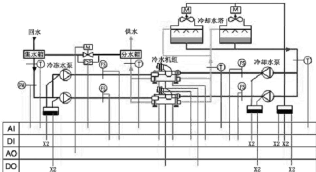
※ 由于冷冻机组已由设备供应商自身智能控制器提供了优化控制,故本系统只考虑对冷冻机组进行监视和控制。
