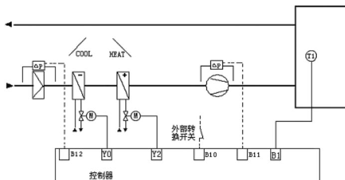
使用说明: 选择分离功能, 组态设置: Y0和B1, Y2和B1, 设置两个独立控制回路的PID参数, 两个回路温度设定值相同。组态分别选择反作用(加热)方式和正作用(表冷)方式。对于四管制新风机组, 冷热不是同时使用的, 和恒温恒湿机组有根本区别。
