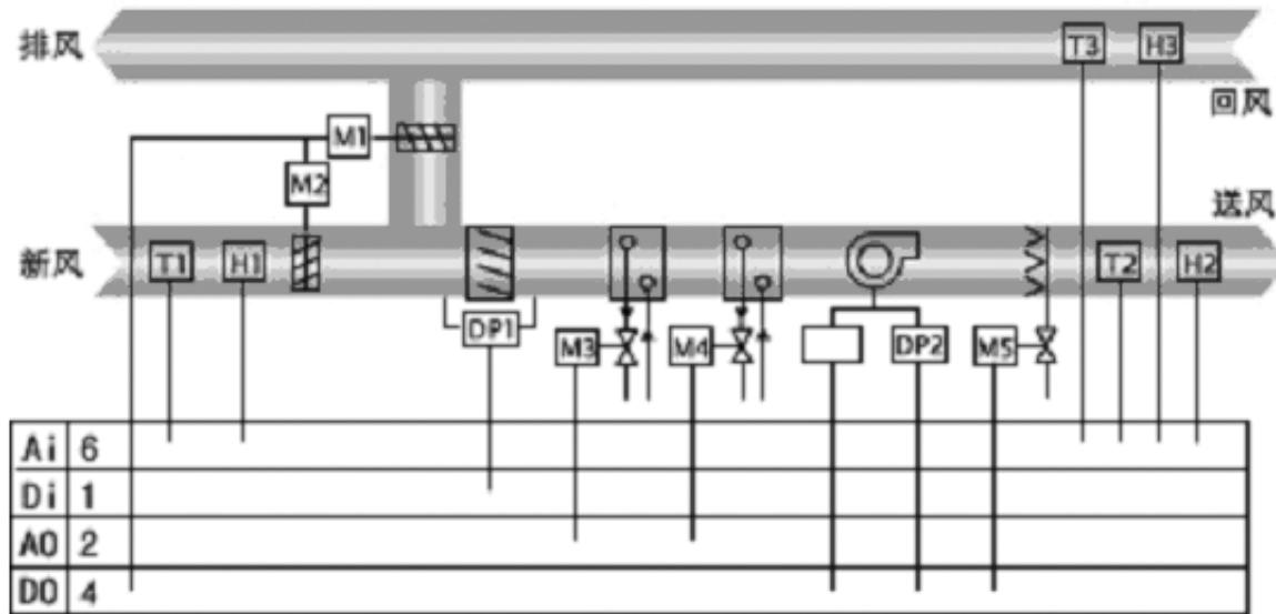
◆ 此原理图是根据1-3层吊顶式空调机组的实际情况而画,如原理图有变,则监控内容和控制方式也随之改变。
