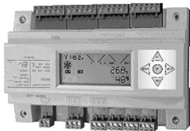
MSFLYER3是一个面向楼宇自控的直接数字控制器。可以对楼宇中的冷冻站、热交换设备、空调系统、通风系统、给排水系统、变配电系统、电梯、照明系统等等设备进行监测和控制。可以十分方便的组网，实现分散控制，集中管理。
